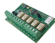
Modulo di espansione auxi relé con 5 uscite relé programmabili
